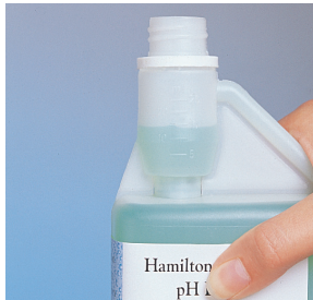
Step 2: fill chamber
